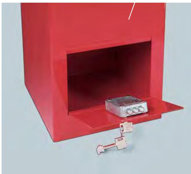
**5 Der Annahme-Schacht** ist ausgestattet mit einem integrierten Fach für Kundendienst-Taschen und einer Entnahmesperre. Die Entnahmesperre bewirkt, dass eingeworfene Taschen von außen nicht wieder entnommen werden können. Zur Montage ist ein Wanddurchbruch erforderlich. Zusätzlich kann eine abschließbare Innenbox montiert werden. Konstruktion aus 2 mm Stahlblech, elektrolytisch verzinkt und pulverbeschichtet.
